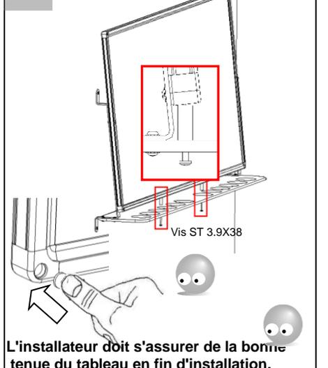
**ATTENTION :** L'assemblage et l'installation de ce produit doivent respecter les instructions ci-jointes. Dans le cas d'une utilisation combinée avec un vidéo projecteur, s'assurer de choisir une surface adaptée afin d'offrir un confort de projection optimal, minimisant les reflets et préférez un vidéoprojecteur ultra courte focale afin d'éviter éblouissement et zones d'ombre.
